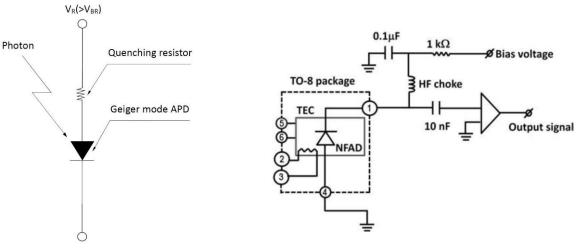
V<sub>R</sub> : Reverse voltage V<sub>BR</sub> : Breakdown voltage
